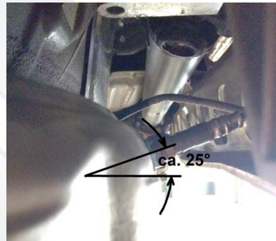
Nach dem einschrauben der Lambdasonde verlegen Sie das Sondenkabel über dem mittel Rohr nach rechts unter die Isolierung nach vorne zum Anschlußstecker.
